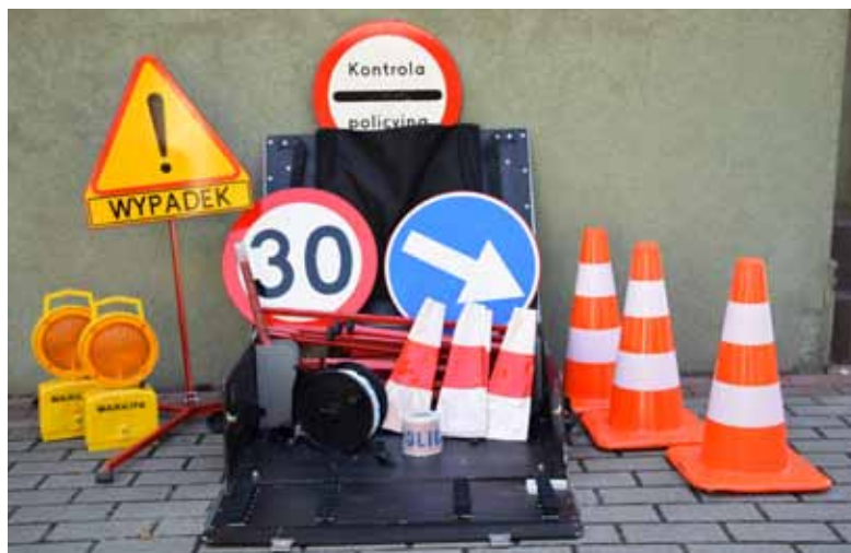
Fot. Zestaw Zapora służący do technicznego zabezpieczenia miejsca zdarzenia drogowego Źródło: Rafał Nowakowski
