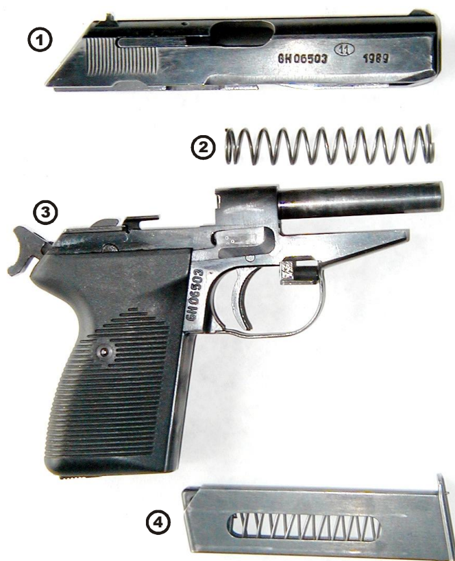
Fot. 6. Pistolet P-83, częściowo rozłożony: 1. zamek; 2. sprężyna powrotna; 3. szkielet z lufą; 4. magazynek
