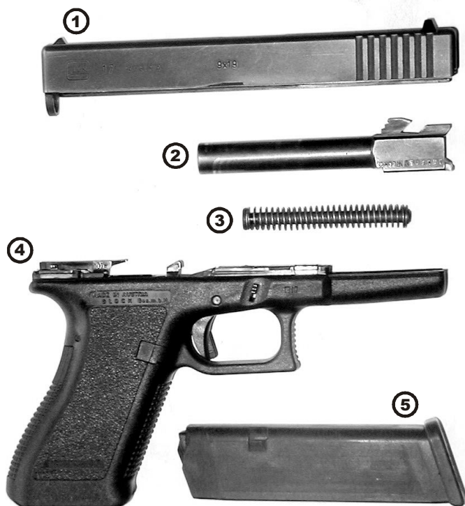
Fot. 11. Pistolet Glock 17, częściowo rozłożony: 1. zamek; 2. lufa; 3. sprężyna powrotna z żerdzią; 4. szkielet; 5. magazynek
