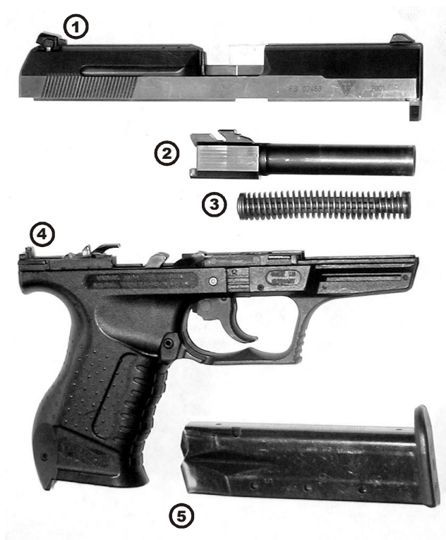
Fot. 14. Pistolet Walther P-99, częściowo rozłożony: 1. zamek; 2. lufa; 3. sprężyna powrotna z żerdzią; 4. szkielet; 5. magazynek
