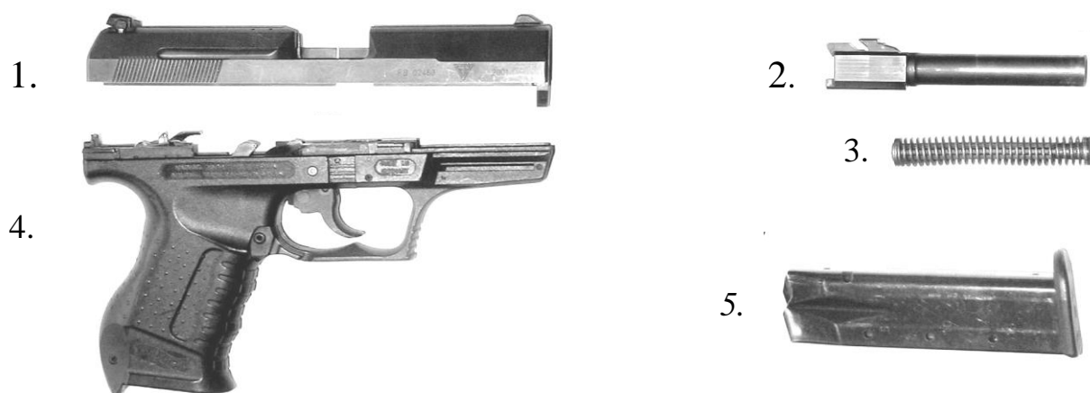
Fot. 12. Pistolet Walther P-99, częściowo rozłożony: 1. zamek; 2. lufa; 3. sprężyna powrotna z żerdzią; 4. szkielet; 5. magazynek
